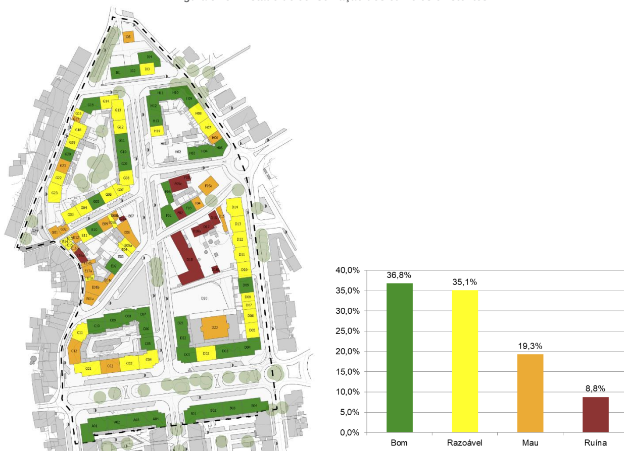
Figura 3.15 – Estado de conservação dos edifícios existentes
