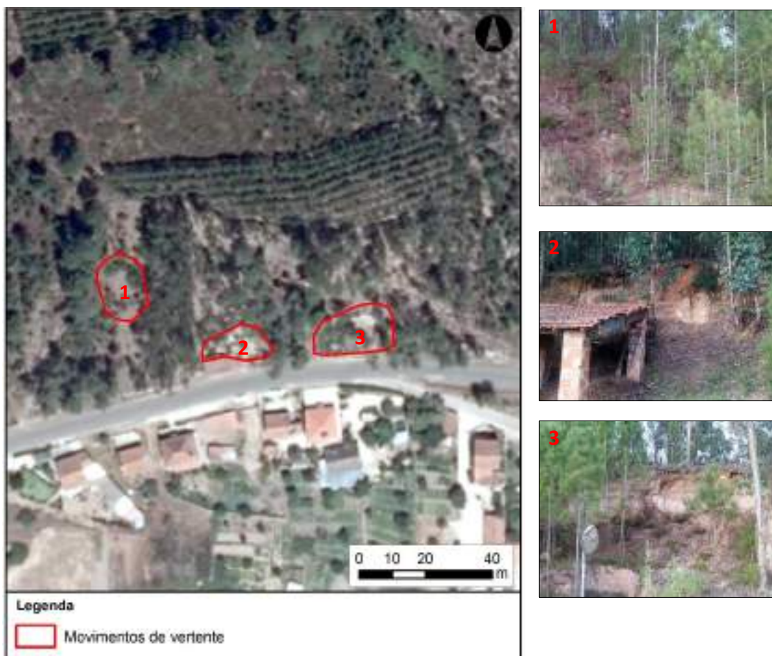
Figura 25 - Exemplos de movimentos de vertente detetados a partir da análise de ortofotomapas à escala de visualização 1:1500 com respetivas fotografias obtidas durante o trabalho de campo
